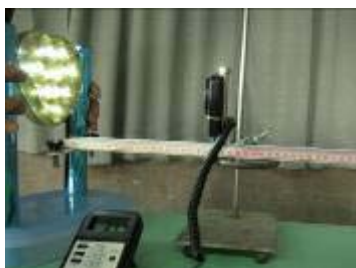
(左上圖) 作品置於照度計前 20 公分測量亮度，進行亮度評分。
