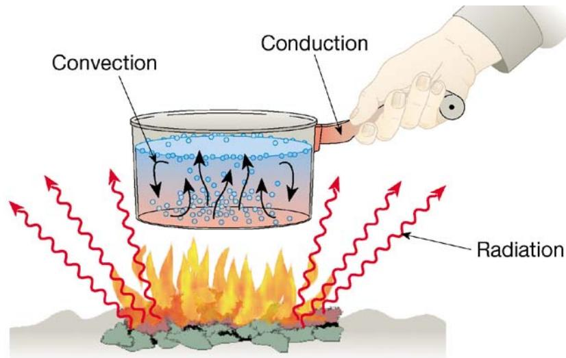
圖 2 热量的傳遞的三種方式
