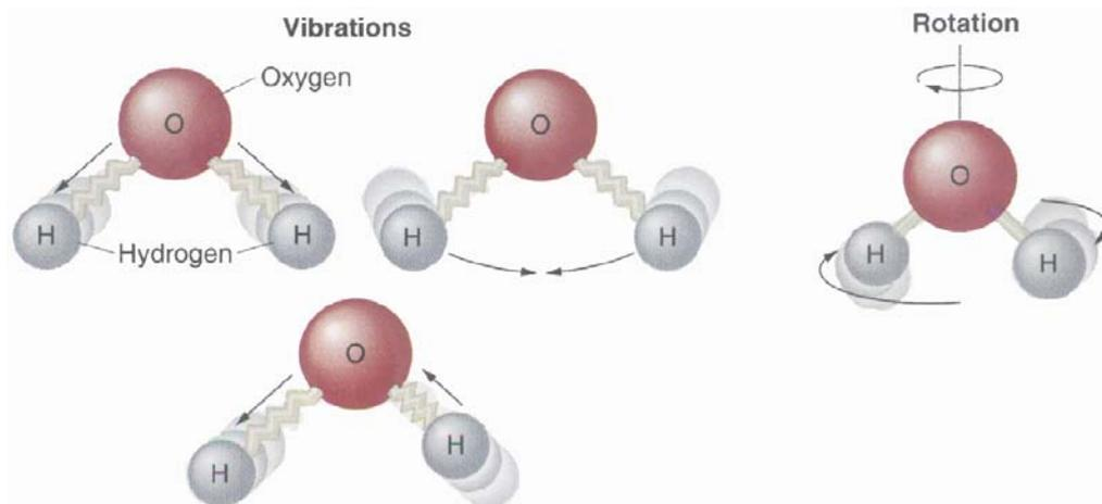
圖 6  $\text{H}_2\text{O}$  溫室氣體吸收輻射熱的反應
