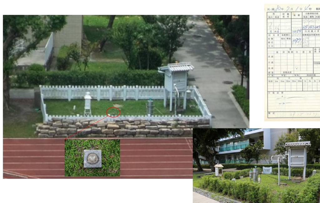
圖二 1992 氣象局新大樓改建期間，台北觀測站搬遷到博愛校區，科學館前面的觀測坪(圖左上)即當搬遷建造(以師範學院站命名)，觀測坪上有標示師範學院站經緯度的地標(圖左下)。右上圖為遷站期間，觀測人員的人工氣象紀錄，師範學院站的觀測從 1992/2/1 到 1997/8/31，接續氣象局改建期間的觀測，台北站氣象觀測才能保有連續性。由於博愛校區空間狹小，加上氣象儀器早已失去觀測功能，目前留下的面積僅有原來的一半(圖右下)，原先放置土壤溫度計與蒸發皿的地點已經改為學生休憩地方。
